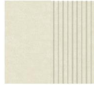
finition étages béton lasuré + matricé
