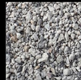
Graviers recyclés issus de la valorisation de déchets du BTP
